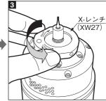
主軸フランジ部に取り付け、ロック側に動かす。
