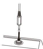
3. 请确认当按下指针安定器上的开关时,千分表上发生振动。
