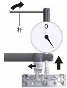
8. 向箭头方向旋转分度衬套,并把分度衬套的前端与盘铣刀侧面的槽部相贴紧。
