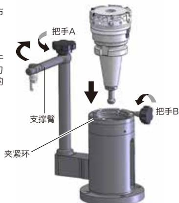
3. 向箭头方向旋转分度衬套,并把分度衬套的前端与盘铣刀侧面的槽部相贴紧。然后拧紧把手A固定支撑臂。此时,分度衬套起快速,准确的分度各刀尖的作用。
