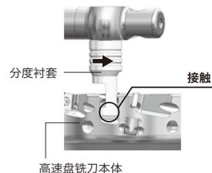
4. 将千分表从支撑臂前端的孔中插入,直到千分表的测头与刀尖接触为止。然后,调节千分表高度当千分表的指针指示在0点前的位置时(如图),拧紧螺丝固定位置。
