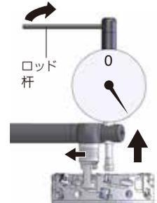
12. 再次对所有刀尖高度进行测定,将误差控制在3微米之内,如果误差过大请再次进行调节。误差越小,加工面越好,刀尖的磨损也会保持一致。另外,也可以使进给速度得到相应的提高。
